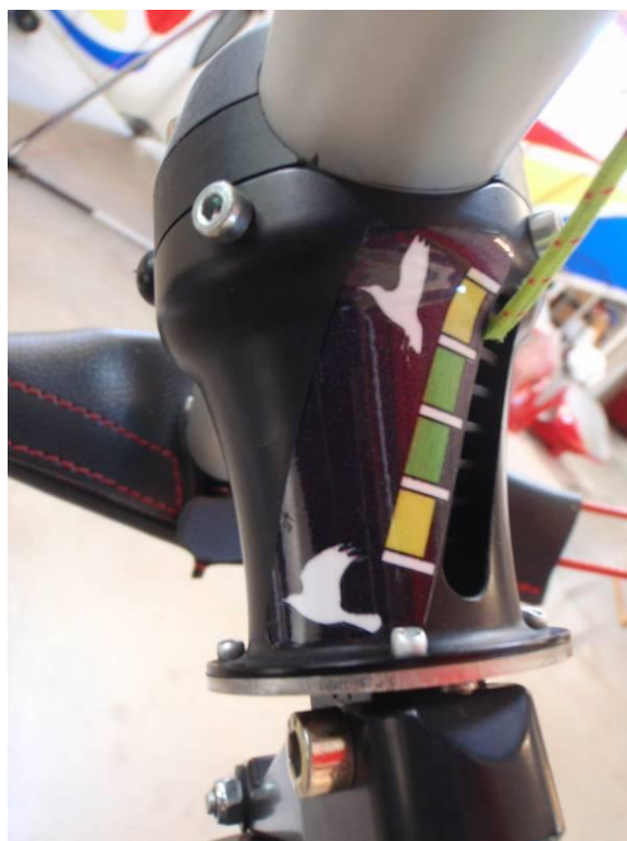
Figure 5-7 : Commande du CORSET
