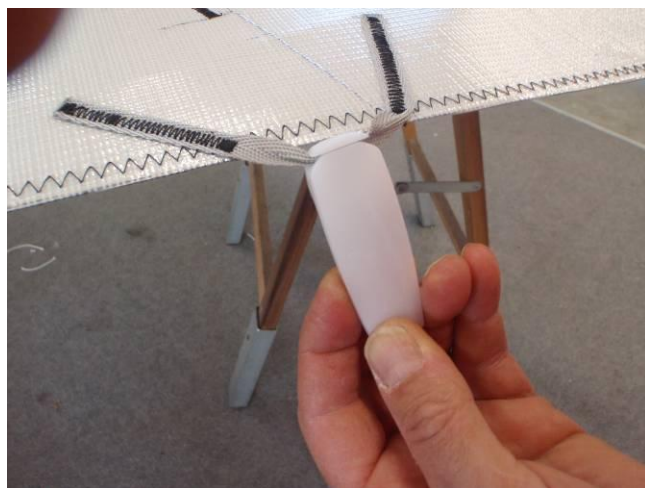
Figure 5-1 : Tendeurs de lattes EasyFit
