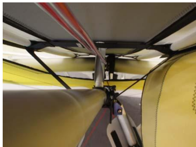
Figure 5-2 : Cheminement des câbles d'étarquage
